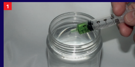
de l'émulseur de classe A est ajouté à l'eau au taux de mélange recommandé par le fabricant.
