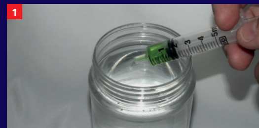
1 Dem Wasser wird Schaummittel Klasse A mit der vom Hersteller empfohlenen Zumischrate beigemischt.
