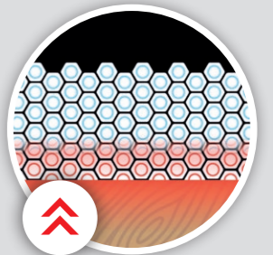
Ableitung von Wärmeenergie durch Anhaftung des Schaums
