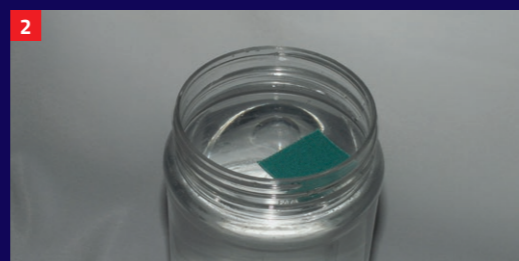
2 Das reine Wasser durchfeuchtet den Stoff nicht, die Oberseite des Stoffs bleibt trocken.
